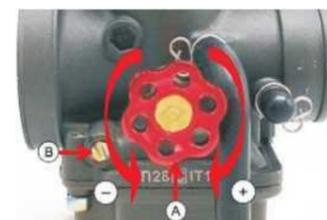
Le réglage au ralenti du carburateur a une grande influence sur le comportement de démarrage du véhicule, sur la marche au ralenti stable et sur la réponse du véhicule lorsque l'accélérateur est ouvert.
