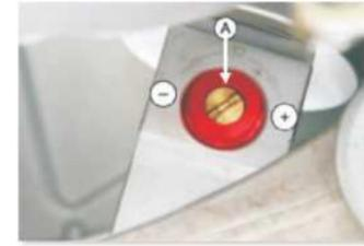
1. Le régulateur d'amortissement de rebond Q est situé à l'extrémité inférieure de l'amortisseur.
